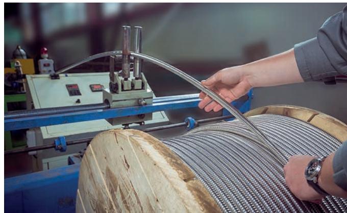
Подача гофрированной трубы IWS для отжига
